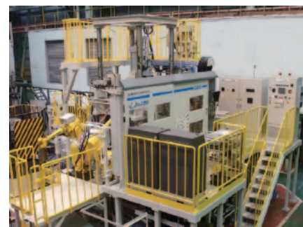
LPDC x HPDC : Hybrid Fill Casting (HFC)
