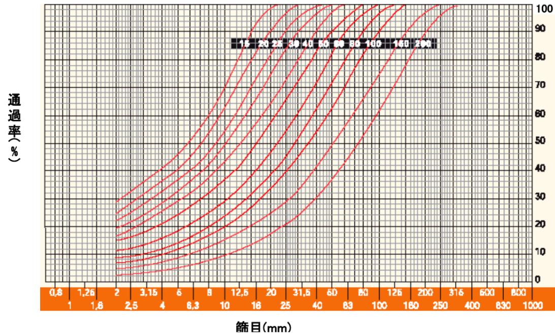
破碎粒度曲線は、供給原料の粒度分布、破碎室形状、原料密度、原料清浄度、原料含水率及び原料の破碎性により変わります。
