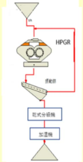
ミルに対してHPGRシステムの方が破碎効率が良い事、HPGRシステムの場合は乾式の為、水処理設備が不要であることから50 t/hのモデルプラントでの試算で38%の省エネ、67KL/年間(1プラント)の燃料削減が可能である。
