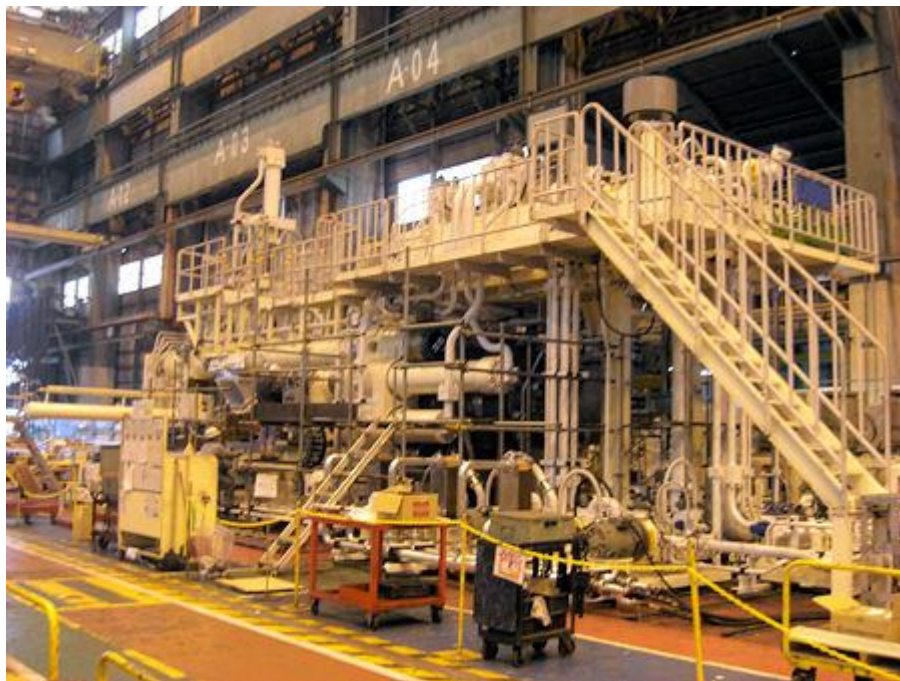
【6000MT NPC-SS/3G 押出プレス同型機の当社工場内完成写真】
