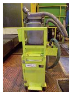
Fig. 10 スラッジ・浮上油回収装置
