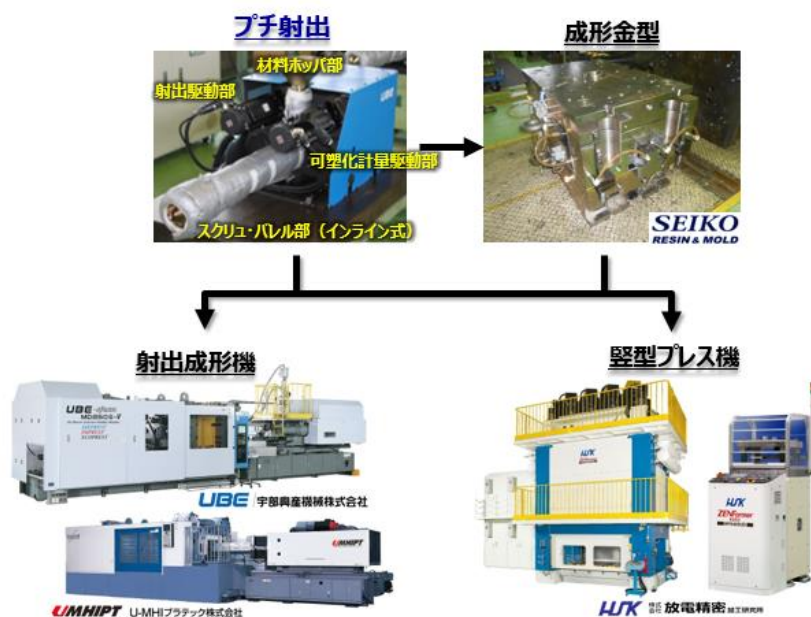
図1 プチ射出の外観及び展開事例
