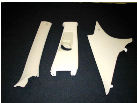
写真3 A,B,Cピラー(ダイプレスト成形品:Cモード)
