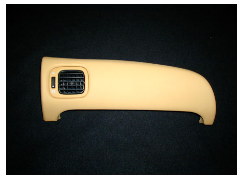
写真5 インストパッド(ダイプレスト成形品:Pモード)
