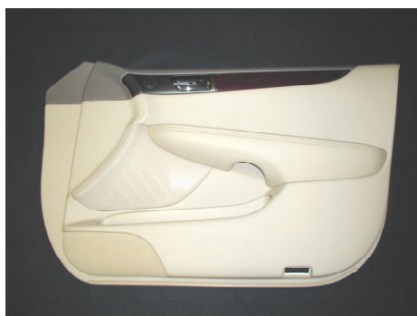
写真4 ドアトリム(ダイプレスト成形品:Pモード)
