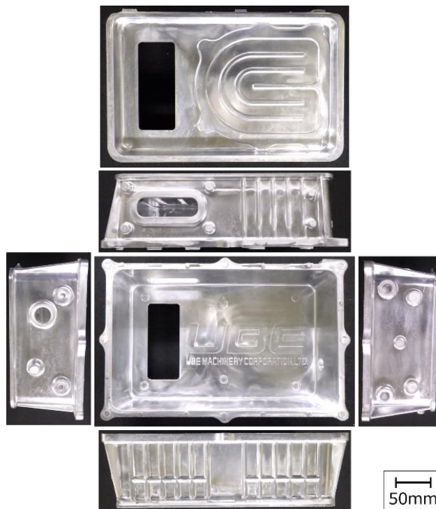
図 24 ハイサイクル铸造した铸造品の外觀写真
