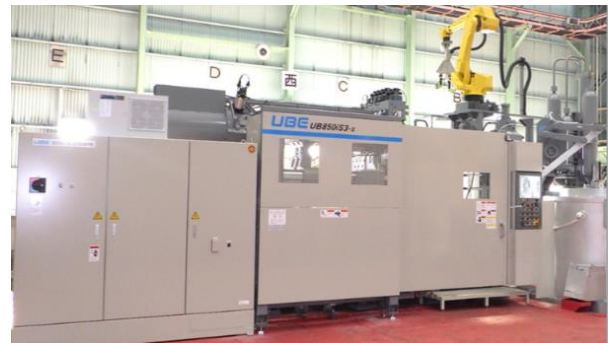
図 2 当社 DC ソリューションセンターに新設されたハイサイクル機の外観
