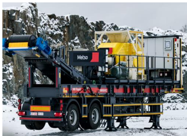
写真8 NWHPGR8外観写真
