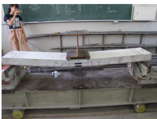
(c) 破壊状況 (F-SR-2 供試体)
